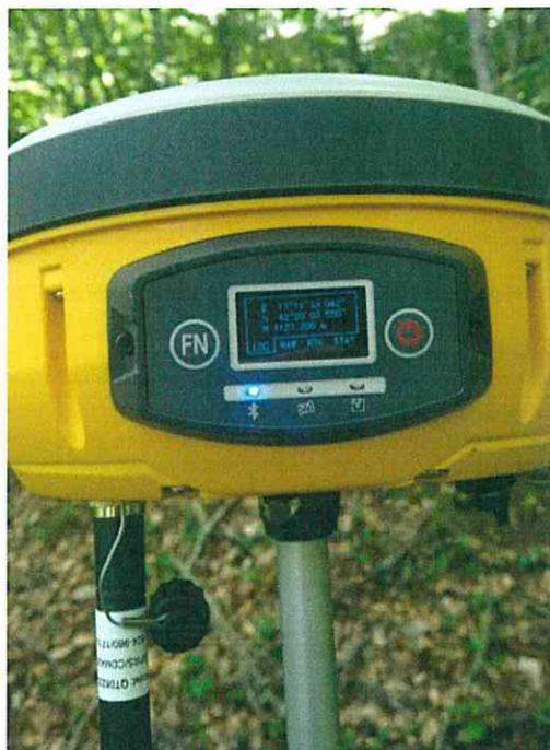
Seguendo il segnale acustico della strumentazione della G.S.A. ho rilevato la condotta idrica, e di tanto in tanto ad intervalli regolari, sono stati rilevati punti topografici GPS.
